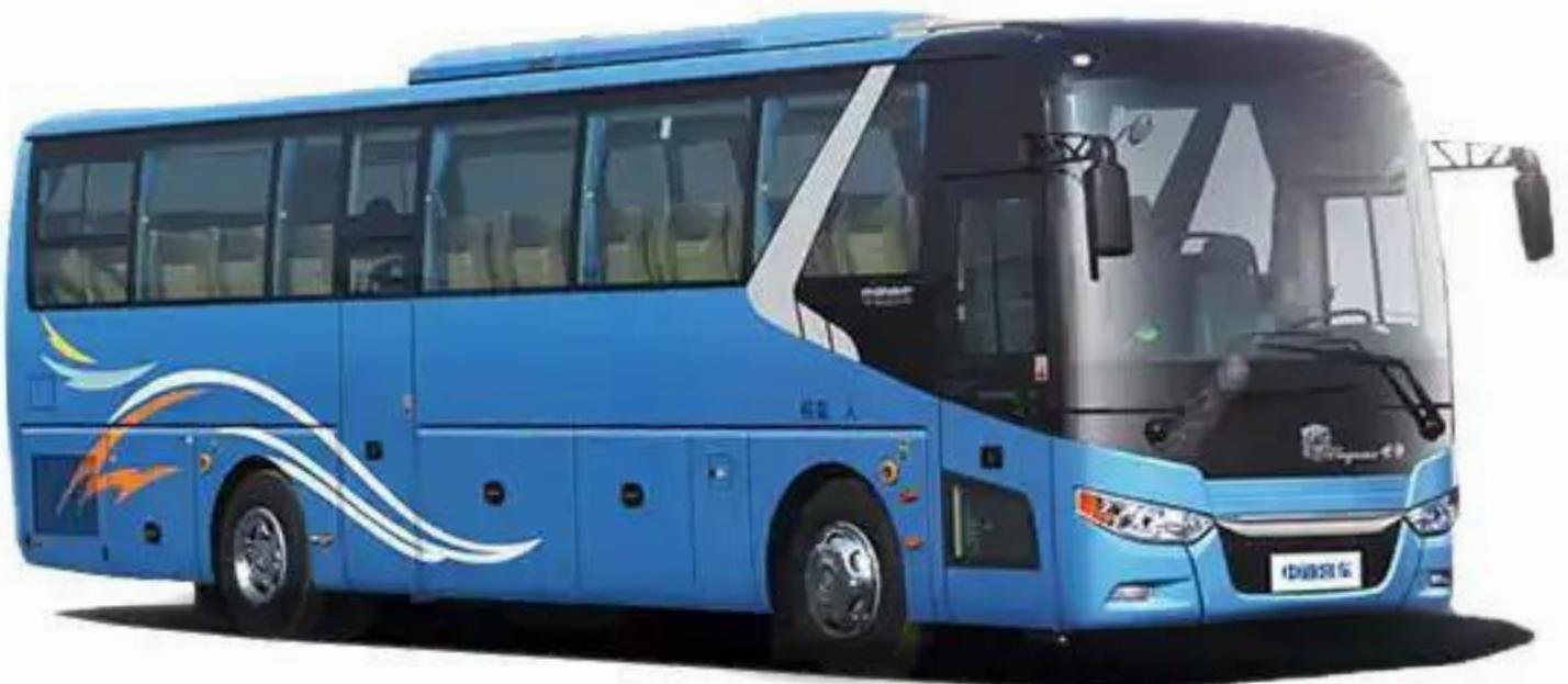
**LCK6898H - Moteur DIESEL CUMMINS EQB210-20 - 6 cylindre en ligne turbo diesel**
